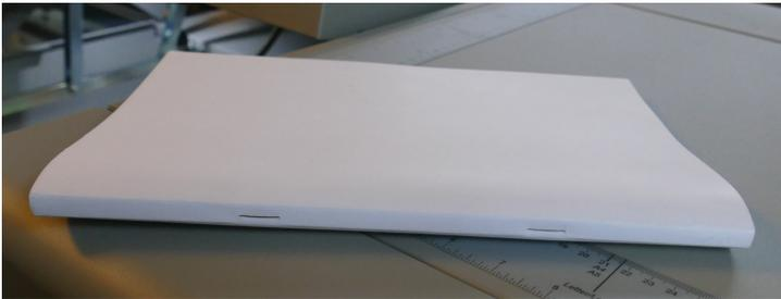
Der 200-Seiten-Test mit der Plockmatic BM5050S hat funktioniert. Von A6 übers A4-quer, von 99 x 210- bis hin zu 320 x 310 mm-Broschüren ist alles möglich.
